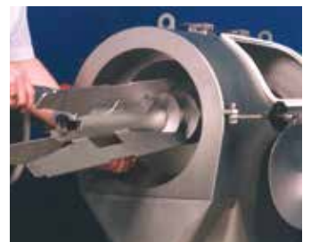
Las piezas internas son fáciles de retirar para su limpieza
